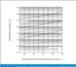
Fig.3-TYPICAL REVERSE CHARACTERISTIC
