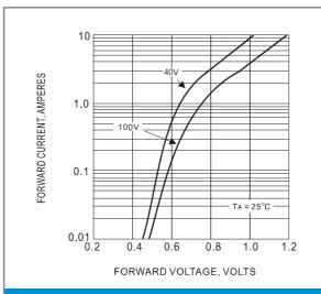
Fig.4-TYPICAL INSTANTANEOUS FORWARD CHARACTERISTIC
