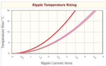
C3225X7R1C106M200AB(100kHz) C3225X7R1C106M200AB(500kHz) C3225X7R1C106M200AB(1MHz)
