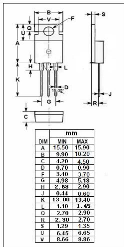
**isc N-Channel MOSFET Transistor****IRFB3206,IIRFB3206****ELECTRICAL CHARACTERISTICS** $T_c=25^\circ\text{C}$  unless otherwise specified
