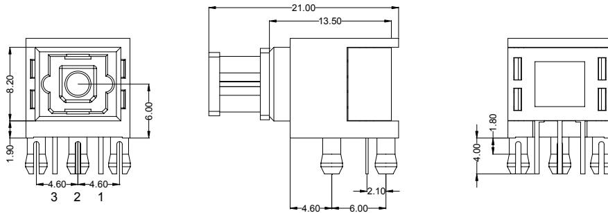
Tolerance: $\pm 0.2\text{mm}$
