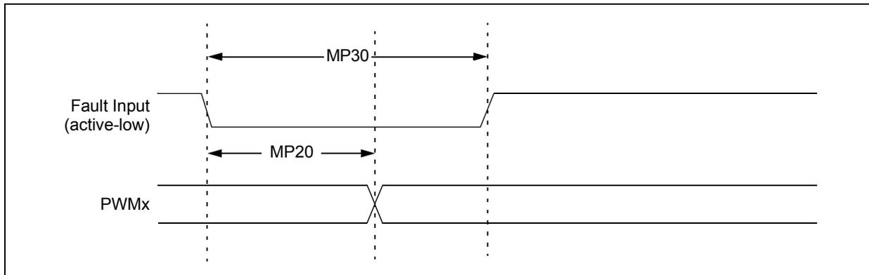
**FIGURE 25-10: HIGH-SPEED PWMx MODULE TIMING CHARACTERISTICS**
