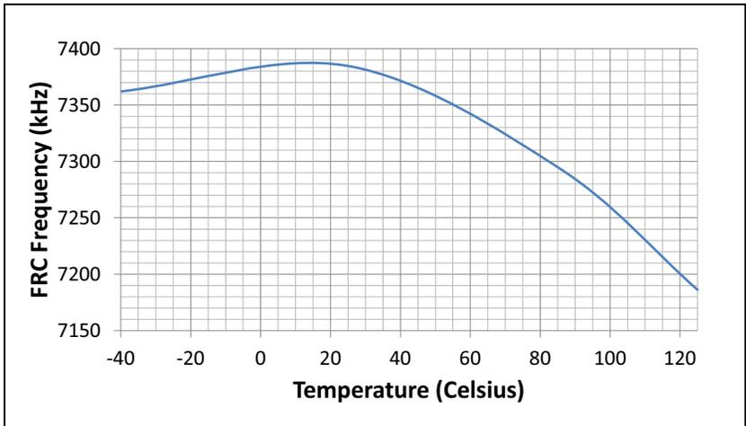
**FIGURE 26-10: TYPICAL LPRC FREQUENCY @ V<sub>DD</sub> = 3.3V**
