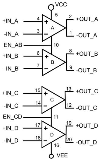
**FIGURE 1: BLOCK DIAGRAM**
