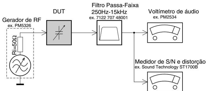
Use um filtro passa-faixa para eliminar ruídos (50Hz, 100Hz) e distorções do tom piloto (19kHz, 38kHz).
