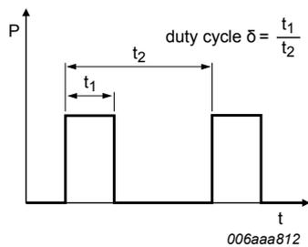
**Fig. 17. Duty cycle definition**
