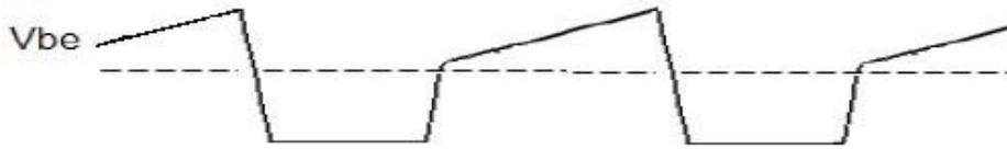
图 6: Vbe 驱动电压波形
