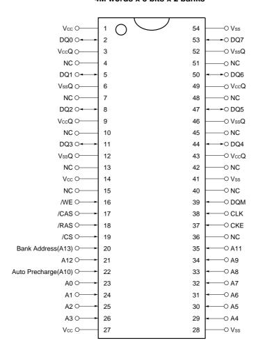
A0 - A13 DQM DQ mask enable : Address inputs CKE A0 - A12 : Row address inputs Clock enable A0 - A6 : Column address inputs CLK System clock input DQ0 - DQ7 Data inputs/outputs Vcc Supply voltage /CS Chip select Vss Ground Supply voltage for DQ /RAS Row address strobe VccQ /CAS : Column address strobe VssQ Ground for DQ
