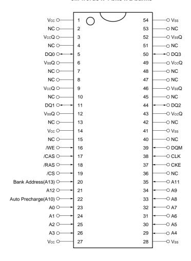
A0 - A13 : Address inputs DQM : DQ mask enable A0 - A12 : Row address inputs CKE Clock enable A0 - A7 Column address inputs CLK System clock input DQ0 - DQ3 Data inputs/outputs Vcc Supply voltage /CS Chip select Vss Ground
