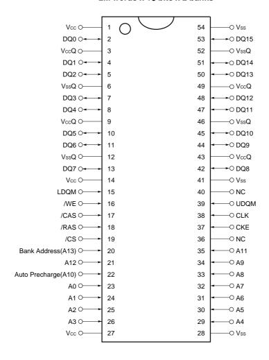
A0 - A13 : Address inputs UDQM : Upper DQ mask enable
