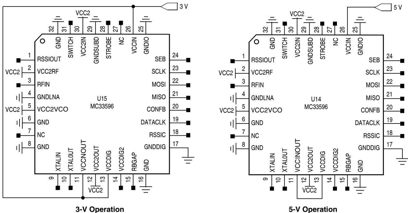
**Figure 2. Wiring Diagrams**
