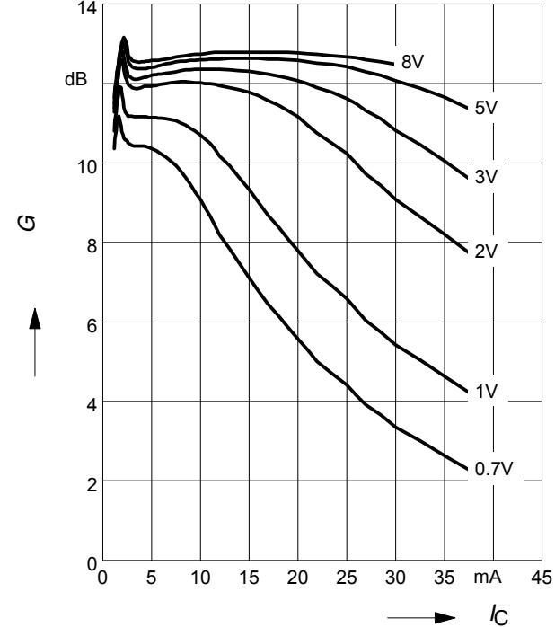
**Power Gain**  $G_{ma}$ ,  $G_{ms} = f(V_{CE})$ :
