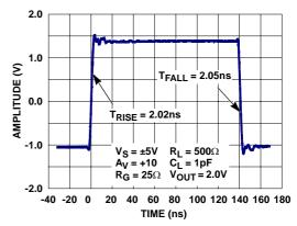
FIGURE 30. LARGE SIGNAL STEP RESPONSE\_RISE AND FALL TIME
