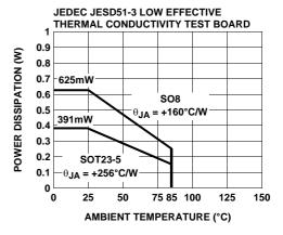
FIGURE 34. PACKAGE POWER DISSIPATION VS AMBIENT TEMPERATURE
