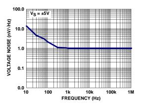
FIGURE 27. EQUIVALENT INPUT VOLTAGE NOISE vs FREQUENCY
