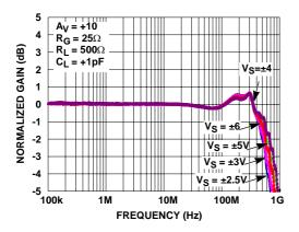
FIGURE 7. GAIN vs FREQUENCY FOR VARIOUS ±VS
