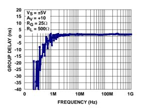
FIGURE 21. GROUP DELAY vs FREQUENCY
