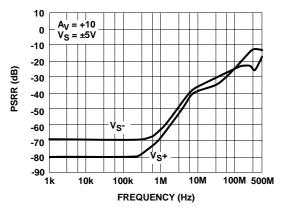
FIGURE 19. PSRR vs FREQUENCY
