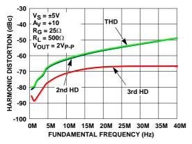
FIGURE 23. HARMONIC DISTORTION vs FREQUENCY
