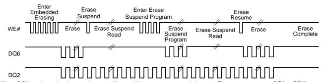
**Note:** DQ2 toggles only when read at an address within an erase-suspended sector. The system may use OE# or CE#f to toggle DQ2 and DQ6.
