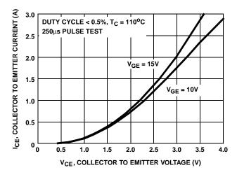
FIGURE 16. COLLECTOR TO EMITTER ON-STATE VOLTAGE
