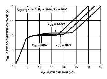
FIGURE 14. GATE CHARGE WAVEFORMS
