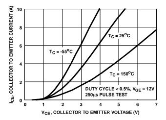
FIGURE 5. COLLECTOR TO EMITTER ON-STATE VOLTAGE
