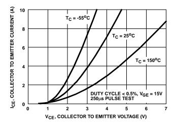
FIGURE 6. COLLECTOR TO EMITTER ON-STATE VOLTAGE
