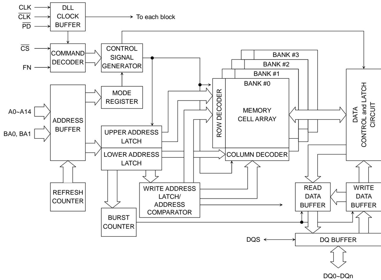
Note: The TC59LM806CFT configuration is 4Bank of  $32768 \times 256 \times 8$  of cell array with the DQ pins numbered DQ0-DQ7.
