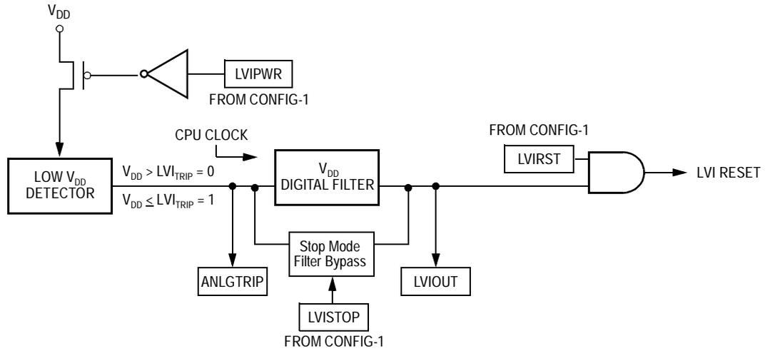
Figure 14-1. LVI Module Block Diagram
