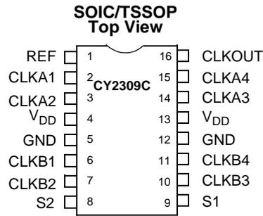
**Table 1. Pin Definition - 16 Pin SOIC/TSSOP**
