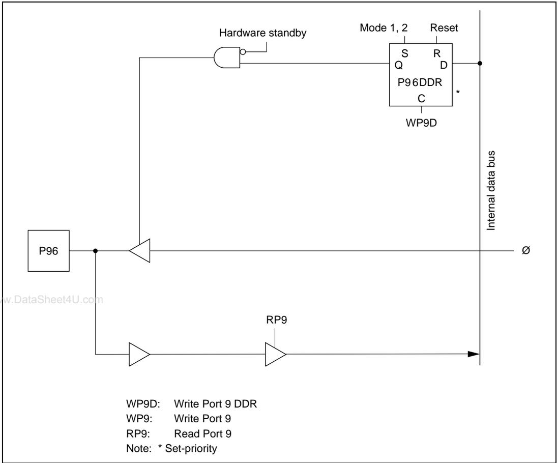
**Figure 6.9 (d) Port 9 Schematic Diagram (Pin P9<sub>o</sub>)**
