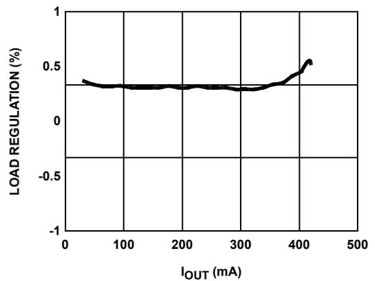
FIGURE 6. LOAD REGULATION - 3.3V V<sub>IN</sub> TO 9V V<sub>OUT</sub> @ 1.2MHz
