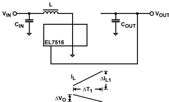
FIGURE 30. BOOST CONVERTER - CYCLE 1, POWER SWITCH CLOSED
