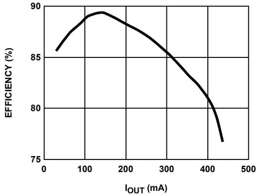
FIGURE 7. EFFICIENCY - 3.3V V<sub>IN</sub> TO 9V V<sub>OUT</sub> @ 600kHz
