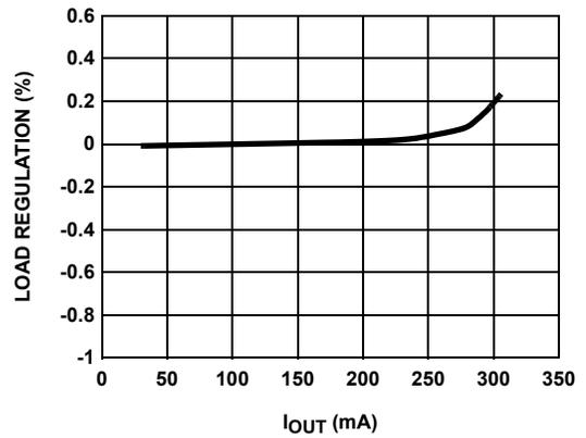
FIGURE 2. LOAD REGULATION - 3.3V V<sub>IN</sub> TO 12V V<sub>OUT</sub> @ 1.3MHz
