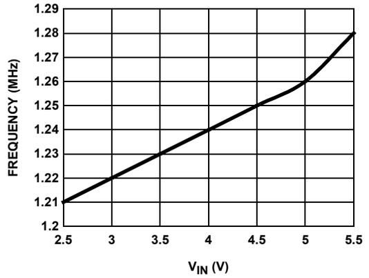
FIGURE 20. FREQUENCY (1.2MHz) vs V<sub>IN</sub>
