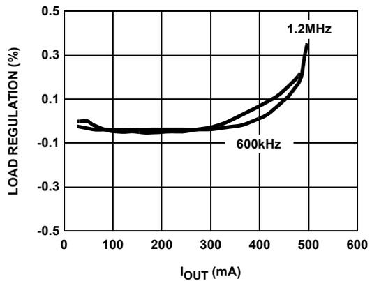
FIGURE 18. LOAD REGULATION - 3.3V TO 8V
