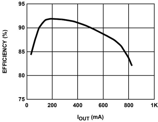
FIGURE 13. EFFICIENCY - 5V  $V_{IN}$  TO 9V  $V_{OUT}$  @ 1.2MHz
