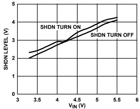
FIGURE 26. TYPICAL SHDN INPUT LEVEL vs  $V_{IN}$
