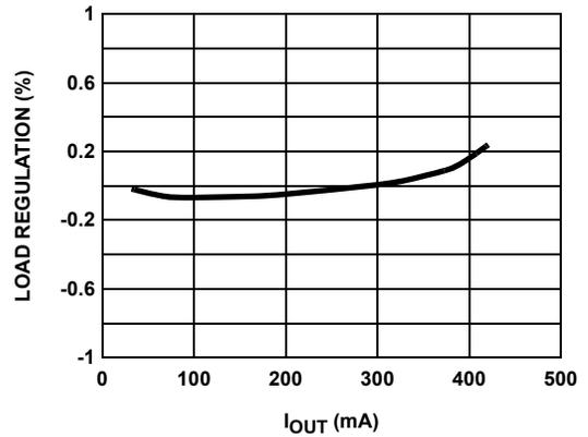
FIGURE 8. LOAD REGULATION - 3.3V V<sub>IN</sub> TO 9V V<sub>OUT</sub> @ 600kHz
