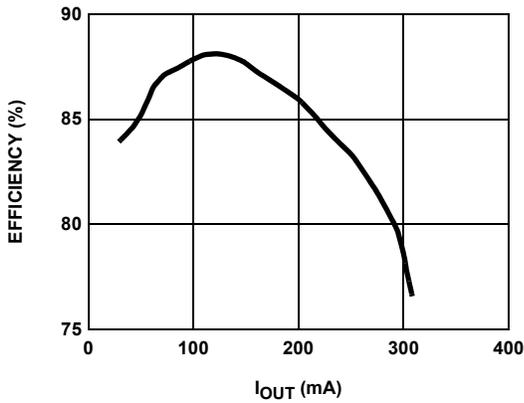
FIGURE 3. EFFICIENCY - 3.3V V<sub>IN</sub> TO 12V V<sub>OUT</sub> @ 620kHz
