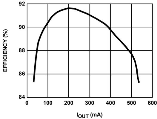
FIGURE 11. EFFICIENCY - 5V V<sub>IN</sub> TO 12V V<sub>OUT</sub> @ 600kHz
