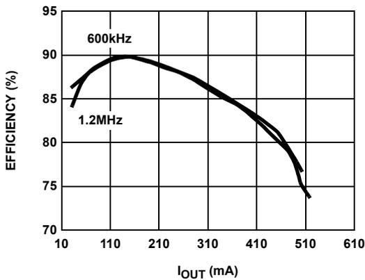
FIGURE 17. EFFICIENCY vs  $I_{OUT}$  - 3.3V TO 8V
