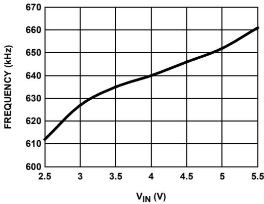
FIGURE 21. FREQUENCY (600kHz) vs V<sub>IN</sub>
