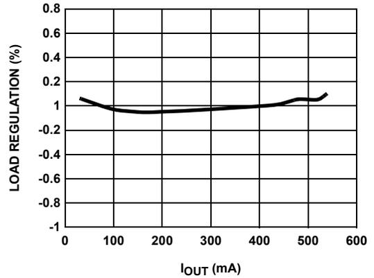
FIGURE 10. LOAD REGULATION - 5V V<sub>IN</sub> TO 12V V<sub>OUT</sub> @ 1.2MHz
