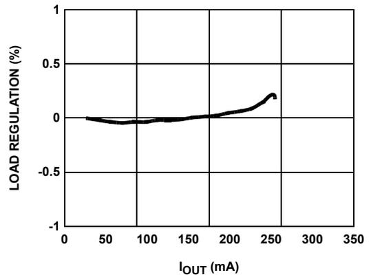
FIGURE 4. LOAD REGULATION - 3.3V V<sub>IN</sub> TO 12V V<sub>OUT</sub> @ 620kHz
