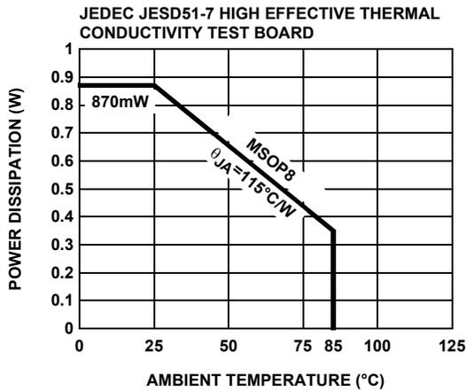
FIGURE 27. PACKAGE POWER DISSIPATION vs AMBIENT TEMPERATURE
