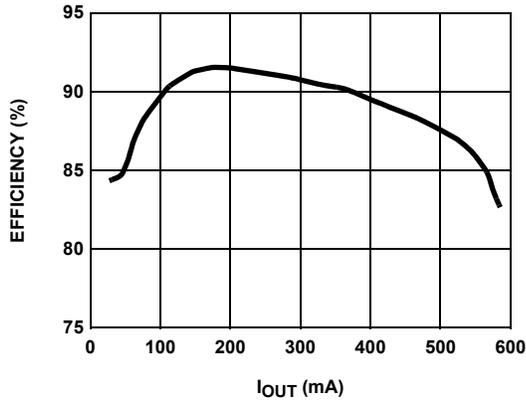
FIGURE 9. EFFICIENCY - 5V V<sub>IN</sub> TO 12V V<sub>OUT</sub> @ 1.2MHz
