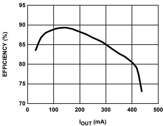
FIGURE 5. EFFICIENCY - 3.3V V<sub>IN</sub> TO 9V V<sub>OUT</sub> @ 1.2MHz
