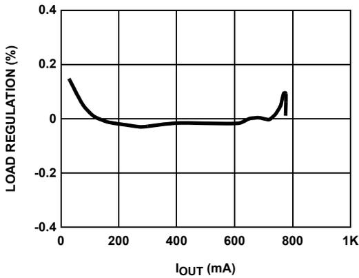
FIGURE 23. LOAD REGULATION - 5V V<sub>IN</sub> TO 9V V<sub>OUT</sub> @ 600kHz
