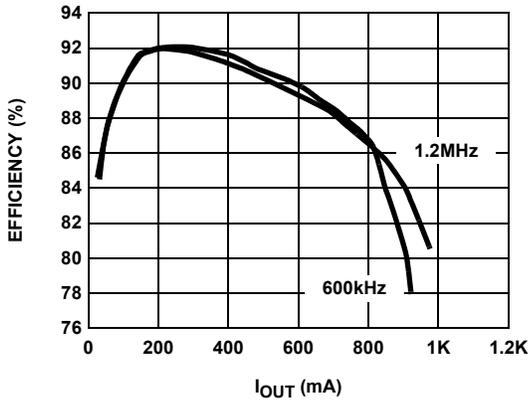
FIGURE 19. EFFICIENCY vs I<sub>OUT</sub>
