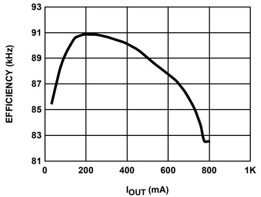
FIGURE 22. EFFICIENCY - 5V V<sub>IN</sub> TO 9V V<sub>OUT</sub> @ 600kHz
