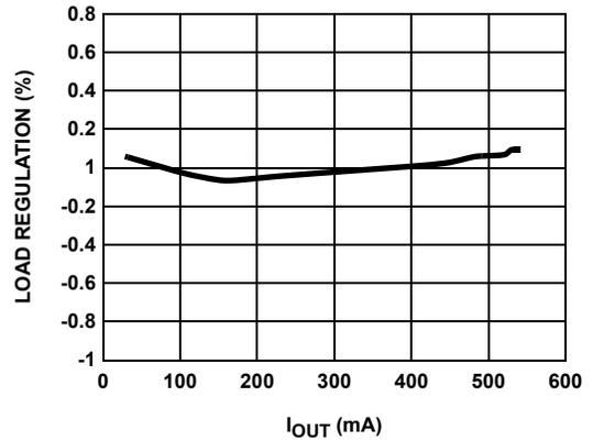
FIGURE 12. LOAD REGULATION - 5V V<sub>IN</sub> TO 12V V<sub>OUT</sub> @ 600kHz
