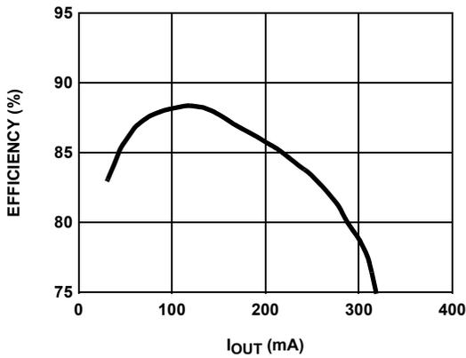
FIGURE 1. EFFICIENCY - 3.3V V<sub>IN</sub> TO 12V V<sub>OUT</sub> @ 1.3MHz
