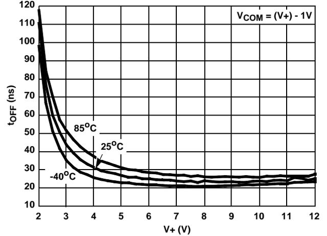
FIGURE 14. TURN - OFF TIME vs SUPPLY VOLTAGE
