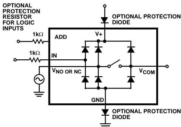
FIGURE 8. OVERVOLTAGE PROTECTION
