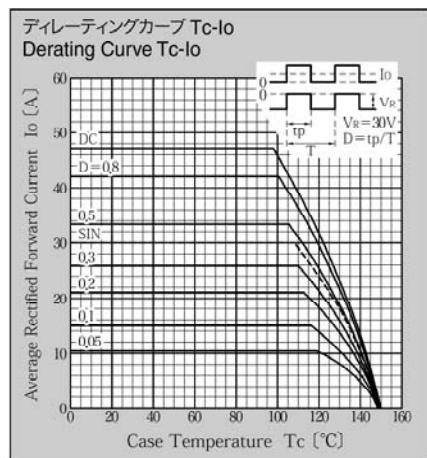
\* Sine waveは50Hzで測定しています。
