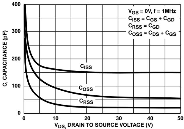
FIGURE 9. CAPACITANCE vs DRAIN TO SOURCE VOLTAGE
