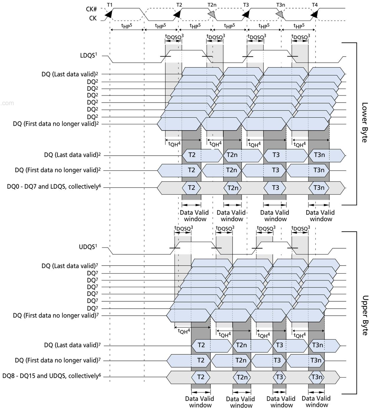
NOTE: 1. DQs transitioning after DQS transition define t<sub>DQSQ</sub> window. LDQS defines the lower byte and UDQS defines the upper byte.
