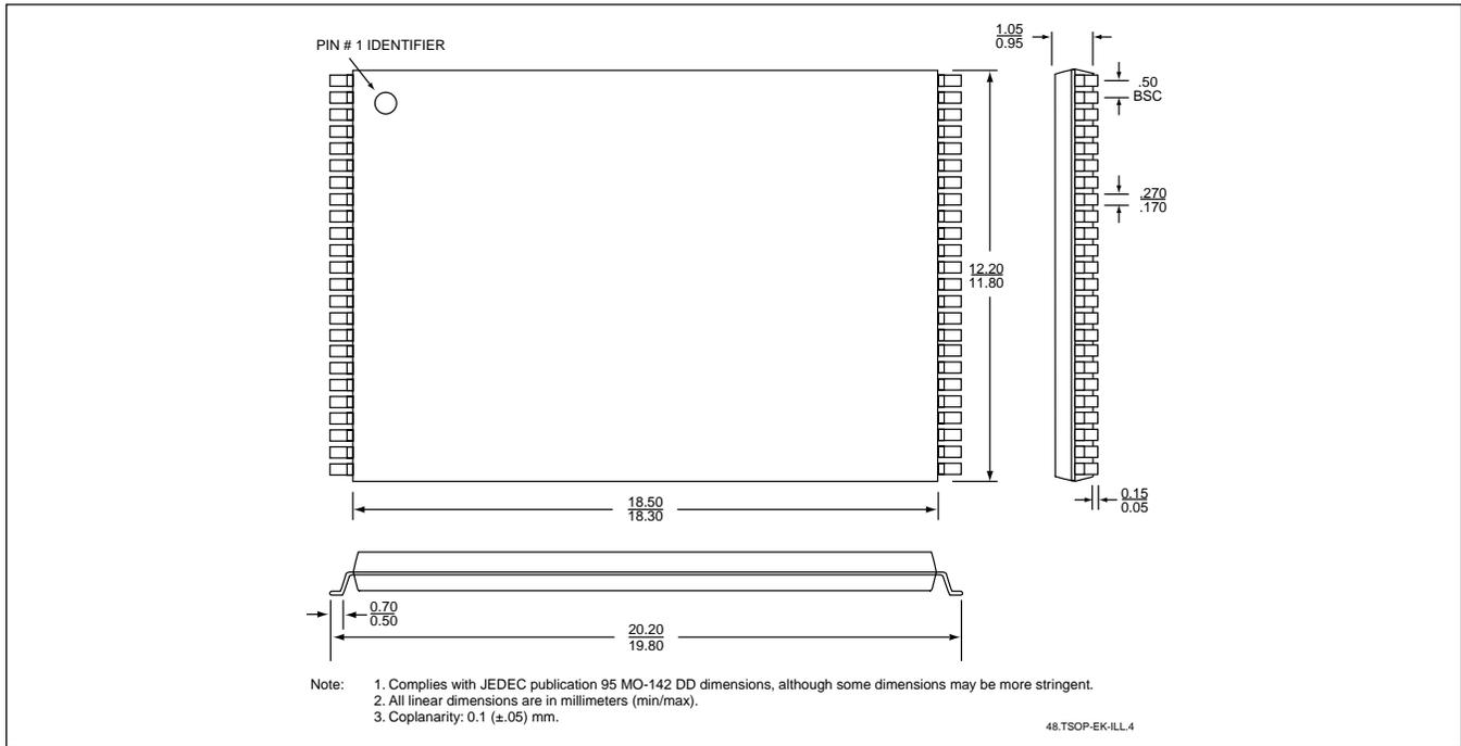
48-PIN THIN SMALL OUTLINE PACKAGE (TSOP) 12MM X 20MM
