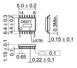
SSOP-B14 (UNIT: mm)
