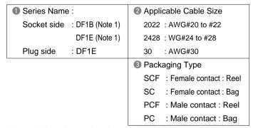
Note 1: When the retainer is used, use DF1E-2022SC(F), DF1B-2428SC(F), and DF1B-30SC(F) contacts.
