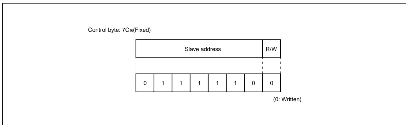
Fig. 16 Control byte configuration
