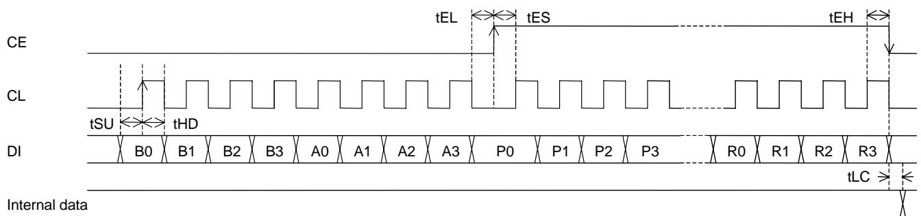
**Serial data output (OUT) tSU, tHD, tEL, tES, tEH $\geq$ 0.75μs tDC, tDH<0.35μs**
