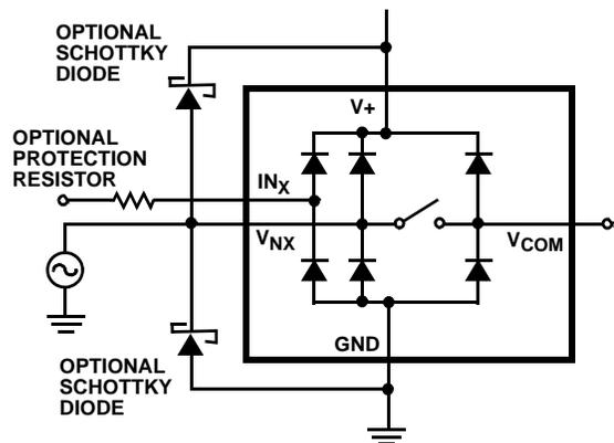
FIGURE 7. OVERVOLTAGE PROTECTION
