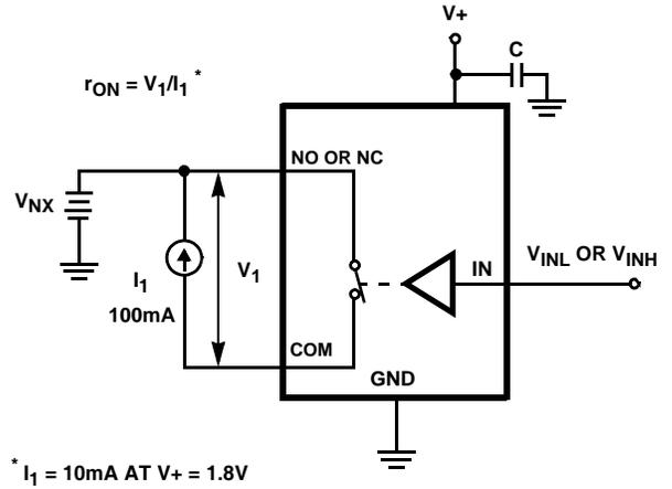
FIGURE 4. r<sub>ON</sub> TEST CIRCUIT
