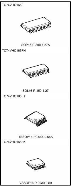
Weight SOP16-P-300-1.27A: 0.18 g (typ.) SOL16-P-150-1.27: 0.13 g (typ.) TSSOP16-P-0044-0.65A: 0.06 g (typ.) VSSOP16-P-0030-0.50: 0.02 g (typ.)
