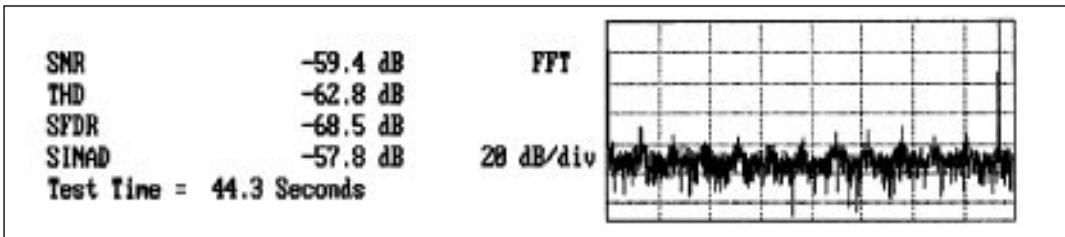
Figure 10. FFT; 48kHz 1V (-14dB) Input;  $F_s=10\text{kHz}$
