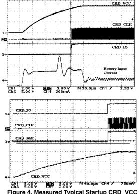
Figure 4. Measured Typical Startup CRD\_VCC Sequence
