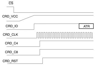
Figure 3. Startup CRD\_VCC Sequence
