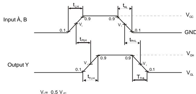
\* -  $V_{CC}=(3.3\pm 0.3) \text{ V}$
