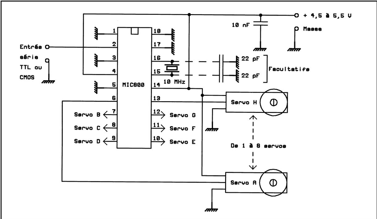
Le schéma ci-dessus est un exemple d'utilisation avec une interface série asynchrone compatible TTL ou CMOS (sortie directe d'un microcontrôleur par exemple). L'adresse du circuit est fixe (ici S) par connexion directe à la masse des pattes AD0 à AD2.
