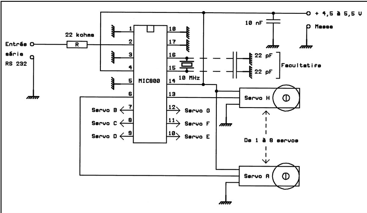
Le schéma ci-dessus est un exemple d'utilisation avec une interface série asynchrone RS 232 standard. Aucun circuit d'interface n'est nécessaire ; la résistance série de 22 kΩ suffit. Par contre, sa valeur ne doit en aucun cas être diminuée. L'adresse du circuit est fixe (ici S) par connexion directe à la masse des pattes AD0 à AD2.
