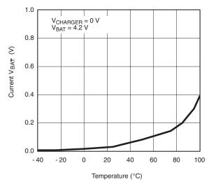
$V_{\mbox{\footnotesize BAT}}$  Leakage vs. Temperature
