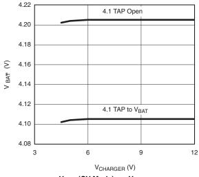
$V_{\text{BAT}}$  (CV Mode) vs.  $V_{\text{CHARGER}}$
