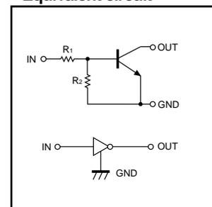
$R_1=1.0\text{k}\Omega / R_2=10\text{k}\Omega$
