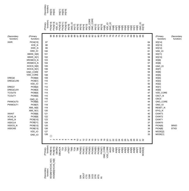
**128-Pin Plastic TQFP**
