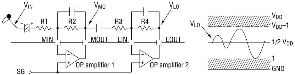
$$V_{LO} = \frac{R4}{R3} V_{MO} = \frac{R2 \cdot R4}{R1 \cdot R3} V_{IN} (V)$$
