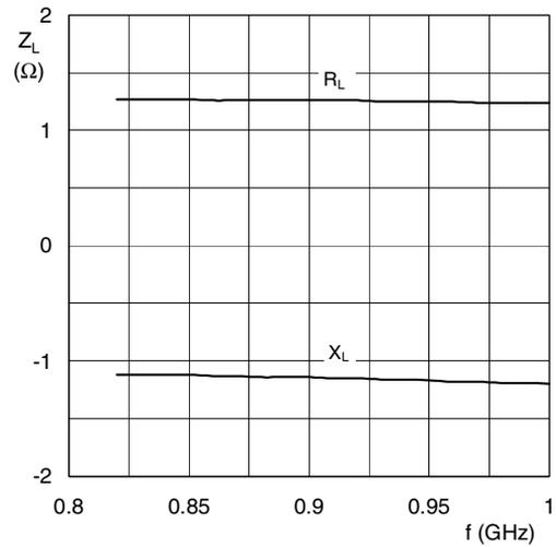
Class-AB operation;  $V_{DS} = 27\text{ V}$ ;  $I_{DQ} = 500\text{ mA}$ ;  $P_L = 18\text{ W}$ .
