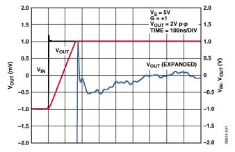
Figure 27. Settling Time
