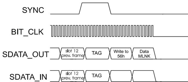
**Figure 34. AC-Link Powerdown Timing**
