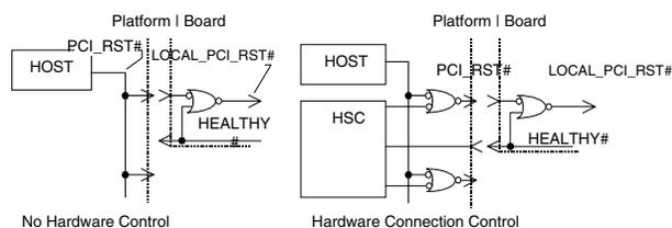
Figure 9-3. PCI Reset
