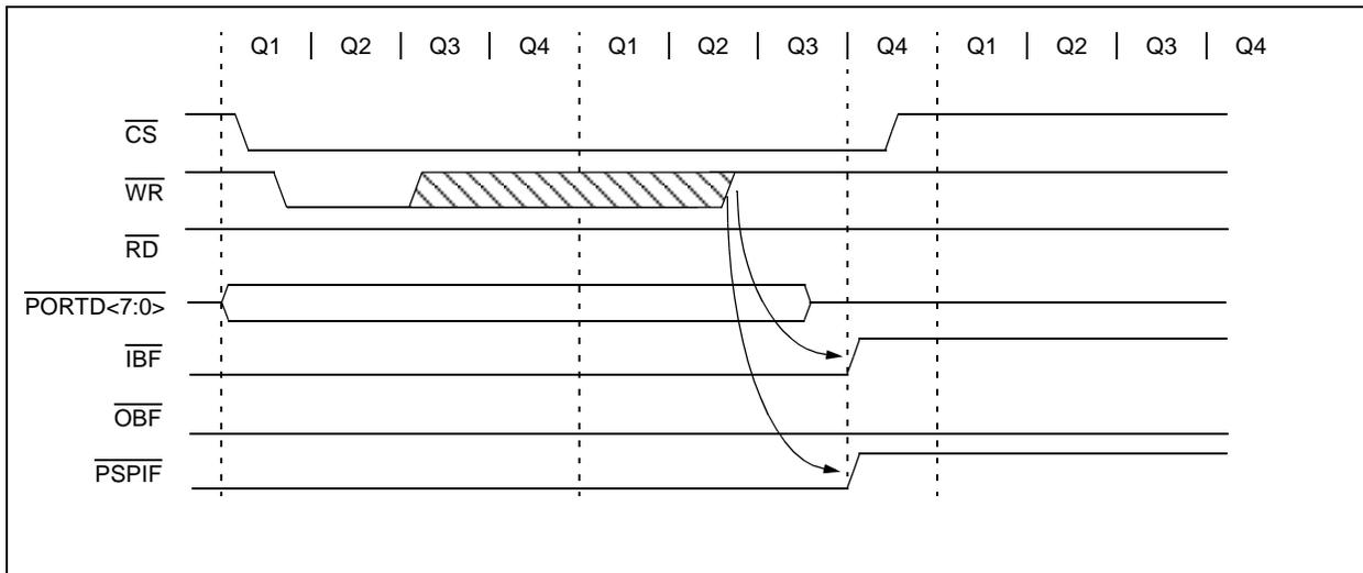
**FIGURE 9-12: PARALLEL SLAVE PORT READ WAVEFORMS**
