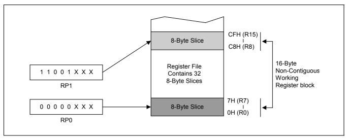
Figure 2-7. Non-Contiguous 16-Byte Working Register Block
