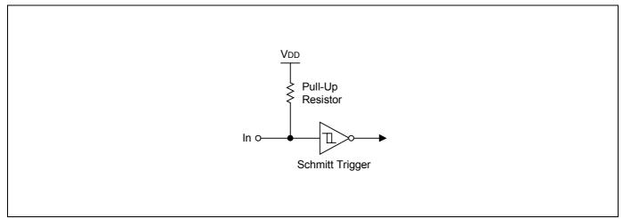
Figure 1-4. Pin Circuit Type B (RESETB)
