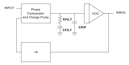
Figure 27. PLL Block Diagram
